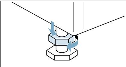
2. Comprobar la nivelación del electrodoméstico con un nivel de burbuja y ajustarla en caso necesario. Modificar la altura girando las patas del electrodoméstico. Las cuatro patas del electrodoméstico deben estar firmemente apoyadas en el suelo.
