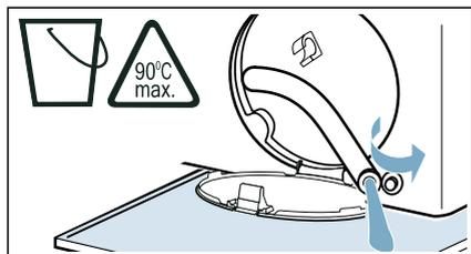
4. Desatornillar con cuidado la tapa de la bomba, puede salir agua residual. Limpiar el interior, la rosca de la tapa de la bomba y la carcasa de la bomba. El propulsor de bomba de desagüe debe ser capaz de girar.
