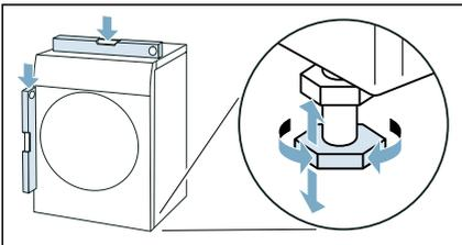
3. Apretar la tuerca de seguridad contra el bastidor. Mientras se aprieta, sujetar la pata firmemente y no ajustar su altura. Las tuercas de seguridad de las cuatro patas deben atornillarse firmemente contra el bastidor.
