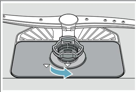
3. Retirar el microfiltro (1). Presionar las lengüetas de retención (2) y extraer los filtros (3).
