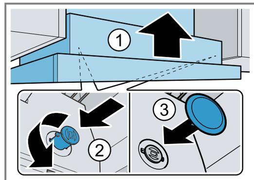
2. Gerätebreite 90 cm: Den Filterauszug vollständig nach vorne ziehen. Das Gerät zusätzlich mit je 2 Schrauben links und rechts von unten an den seitlichen Oberschränken festschrauben.
