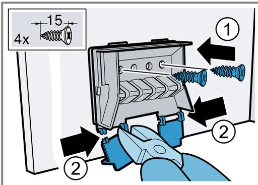
10. An den Befestigungsteilen die Anschläge unten entfernen.
