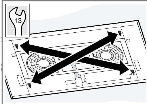
**15.** Retirez l'appareil des trous de fixation.
