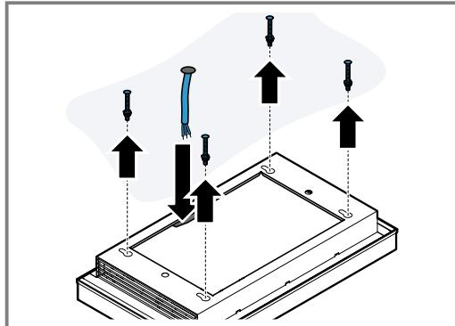
4. Das Gerät bis zum Anschlag in die 4 Schlüssellochöffnungen mit den Führungshülsen einschieben.
