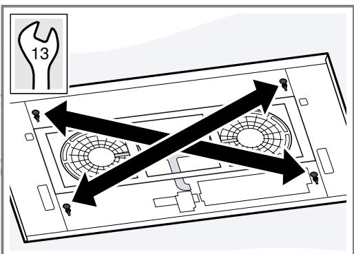
Om ervoor te zorgen dat het apparaat niet kantelt, de kraagmoeren stuksgewijs aantrekken.
