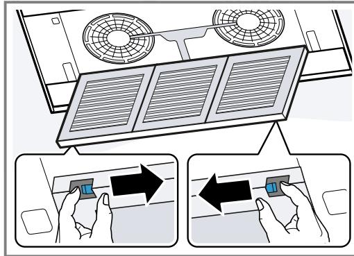
**9.** De geurfilter verwijderen.
