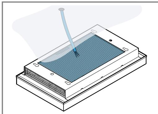
3. Das bauseitige Kabel durch die Öffnung führen und das Gerät in die Befestigungsschrauben an der Decke einhängen.
