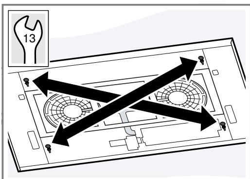
Serrez les écrous à collette un à la fois pour que l'appareil ne s'incline pas.
