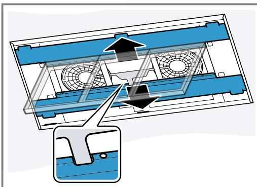
3. De zij-afdekkingen in de richting van het apparaatframe schuiven en vastschroeven.
