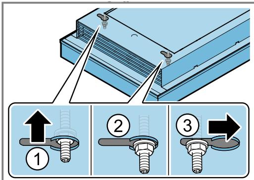
6. Die diagonal gegenüberliegenden Bundmuttern vorsichtig festziehen, bis das Gerät flächenbündig an der Decke anliegt.
