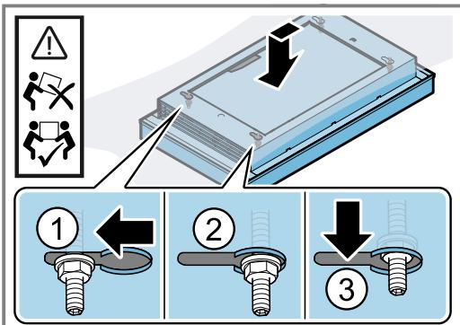
16. Het apparaat langzaam naar onderen toe verwijderen.
