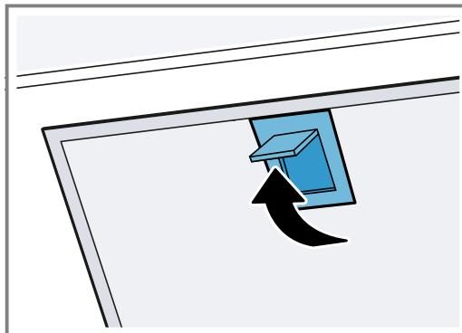
4. Retirez les filtres à graisse des fixations. Pour éviter l'égouttement de graisse, tenez les filtres à graisse à l'horizontale.
