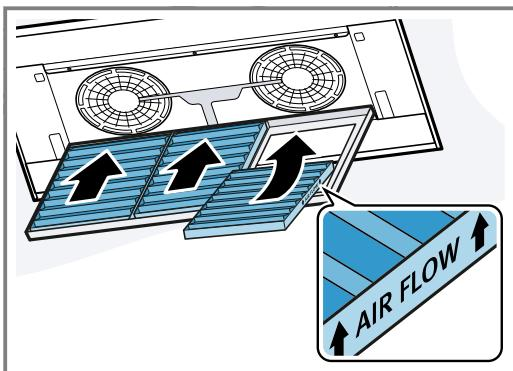
Den Geruchsfilter in korrekter Richtung einsetzen.
