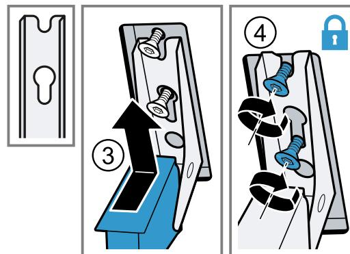
3. De bevestigingsschroeven van de scharnieren aantrekken.
