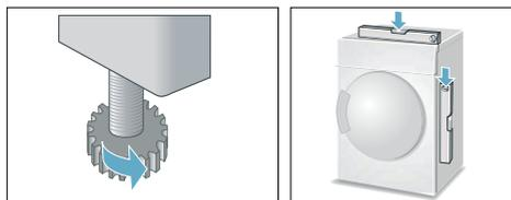
Una nivelación incorrecta puede provocar un elevado nivel de ruido, vibraciones y un movimiento inadecuado del tambor.
