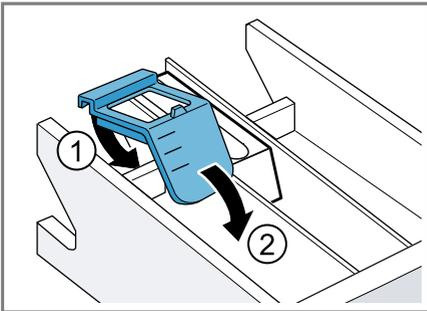
3. Die Waschmittelschublade einsetzen.
