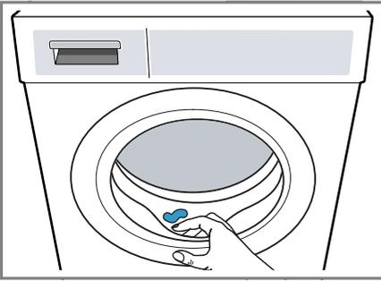
4. Die Tür und die Waschmittelschublade offen lassen, damit Restwasser abtrocknen kann.
