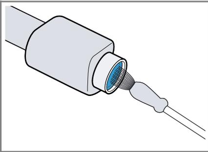
3. Den Wasserzulaufschlauch anschießen und auf Dichtheit prüfen.
