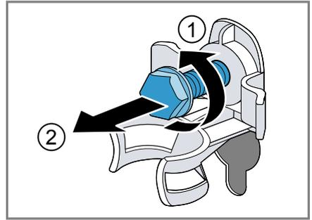
3. Die Netzanschlussleitung aus der Halterung ziehen.
