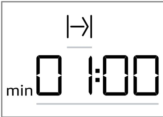
**Valor activo** Si un valor puede ajustarse directamente, aparecerá resaltado con una línea blanca y con un subrayado rojo. El valor activo se puede cambiar con el mando giratorio.
