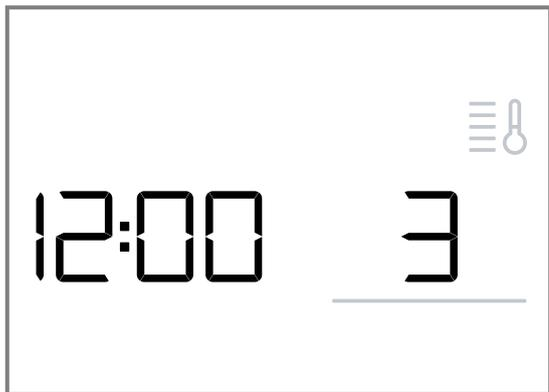
Una vez iniciado el funcionamiento, el termómetro se ilumina y las barras colindantes se completan para indicar el progreso de calentamiento de la temperatura de la cavidad interior. Cuando todas las barras están completas, el aparato se calienta. Cuando se asa al grill, las barras se completan inmediatamente.
