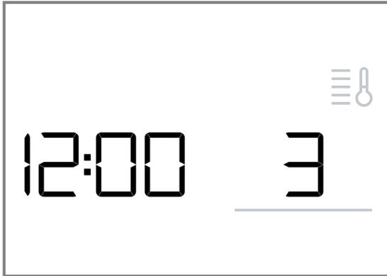
Nach dem Betriebsstart leuchtet der Thermometer und die Balken daneben füllen sich, um den Aufheizfortschritt der Garraumtemperatur anzuzeigen. Wenn alle Balken gefüllt sind, ist das Gerät aufgeheizt. Bei Grill sind die Balken sofort gefüllt.
