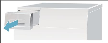
2. Vaciar el agua condensada.
