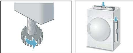
Una posición inadecuada puede causar ruidos molestos, vibraciones y un giro defectuoso del tambor.
