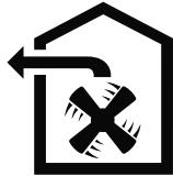
De lucht mag niet worden afgevoerd in een schoorsteen die wordt gebruikt voor afvoergassen van apparaten bestemd voor het verbranden van gas of andere brandstoffen (dit geldt niet voor ventilatieapparatuur).
