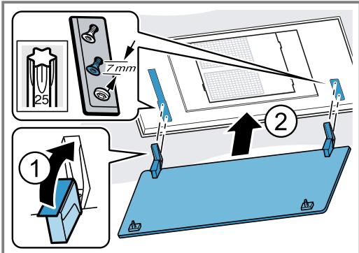
**2. Accrochez le capot du filtre sur les vis prévues et poussez-le vers l'arrière/l'avant selon la forme du trou de serrure dans le rétrécissement.**
