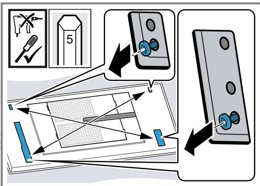
Die Schrauben nicht vollständig lösen.
