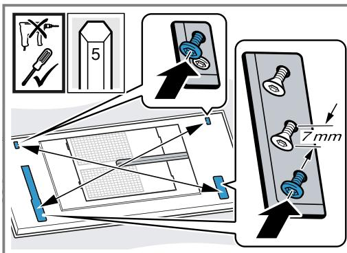
Visser les vis une par une pour que l'appareil ne se déforme pas dans la découpe.
