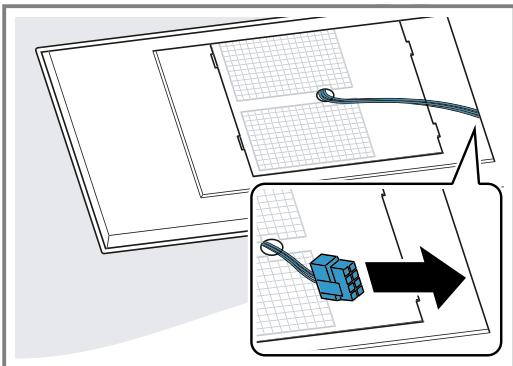
9. Den Kabelkanal zusammendrücken und aufsetzen.
