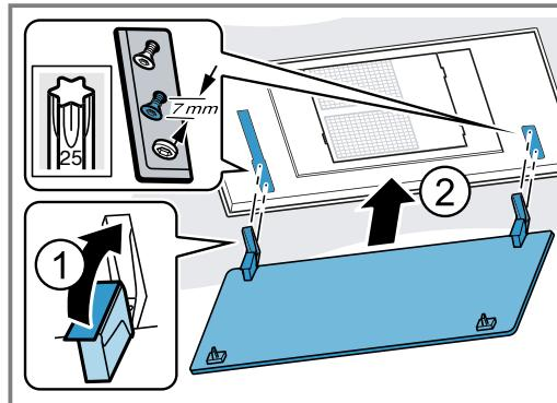
2. De filterafdekking aan de daarvoor bestemde schroeven inhangen en afhankelijk van de sleutelgatopening naar achteren/voren in de nauwe opening schuiven.
