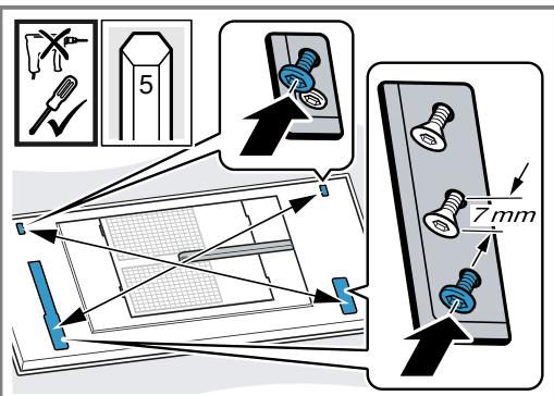
Damit das Gerät nicht im Ausschnitt verkantet, die Schrauben stückweise anziehen.
