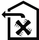
L'aria non deve essere deviata in un cammino che viene utilizzato per lo scarico di gas di apparecchi che bruciano gas o altri combustibili (questo non vale per apparecchi a ricircolo d'aria).
