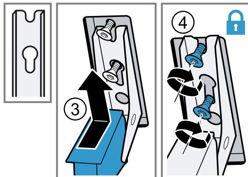
3. Die Befestigungsschrauben der Scharniere festziehen.
