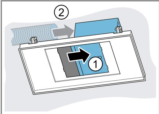
7. Den Lüfterkasten mittig positionieren und festschrauben.
