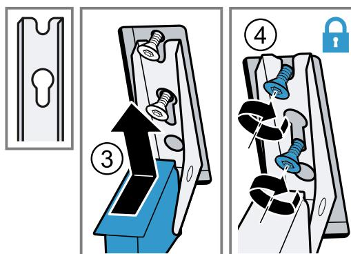
3. De bevestigingsschroeven van de scharnieren aantrekken.
