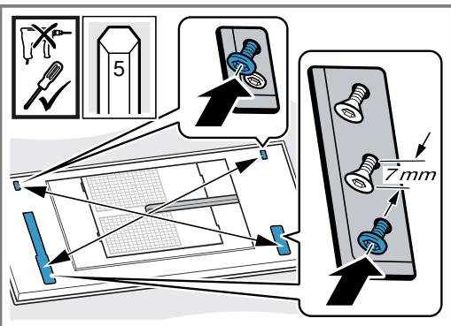
Om ervoor te zorgen dat het apparaat niet in de uitsparing kantelt, de schroeven een voor een aantrekken.
