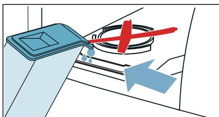
**Hinweis:** Wenn Sie mehr als 180 ml Trinkwasser in das Gerät gießen und im Display nicht erlischt, wurde das Trinkwasser in die falsche Einfüllöffnung gegossen oder das Gerät nicht korrekt ausgerichtet. Gießen Sie das Trinkwasser in die vordere Einfüllöffnung oder richten Sie das Gerät korrekt aus. → "Gerät aufstellen" auf Seite 13
