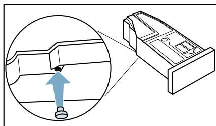
3. Sieb im Kondenswasser-Behälter reinigen. → Seite 52
