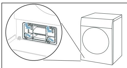
3. Wärmetauscher-Abdeckung am Griff herausziehen.
