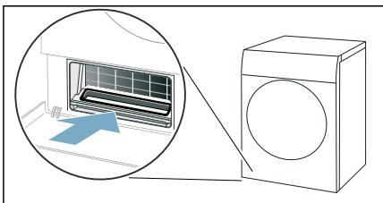
11. Wärmetauscher-Abdeckung am Griff einschieben.
