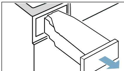
9. Den Kondenswasser-Behälter bis zum Einrasten einschieben.
