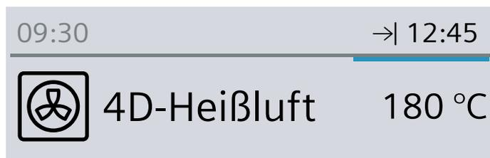
Der Backofen ist in Warteposition. In der Statuszeile erscheint das Symbol → und die Zeit, wann der Betrieb fertig ist. Der Betrieb startet zum richtigen Zeitpunkt. Die Dauer läuft sichtbar in der Statuszeile ab.
