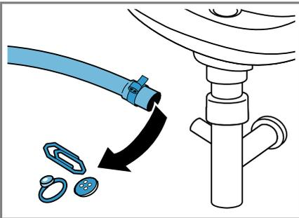
5. Den Wasserablaufschlauch aufstecken und die Anschlussstelle mit der Schlauchschelle sichern.
