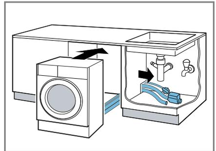
5. Den Wasserzulaufschlauch anschließen.
