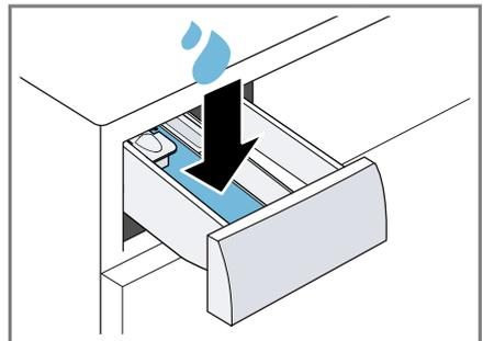
5. Das Pulvervollwaschmittel in die Kammer II einfüllen.
