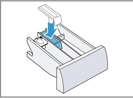
6. Die Öffnung für die Waschmittelschublade reinigen.
