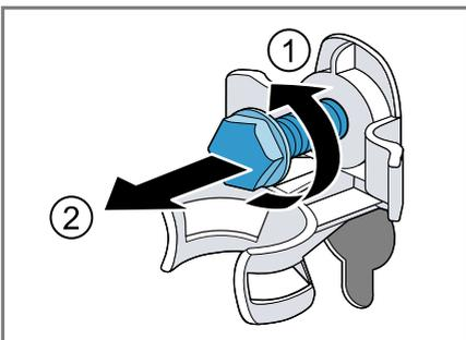
3. Die Netzanschlussleitung aus der Halterung ziehen.
