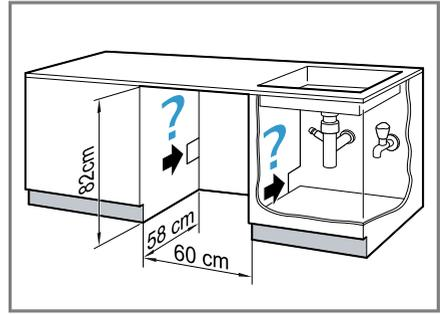
3. Die Netzanschlussleitung sowie den Wasserzulauf- und den Wasserablaufschlauch verlegen.
