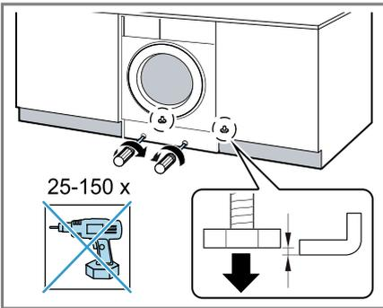
8. Das Gerät mit einer Wasserwaage ausrichten.
