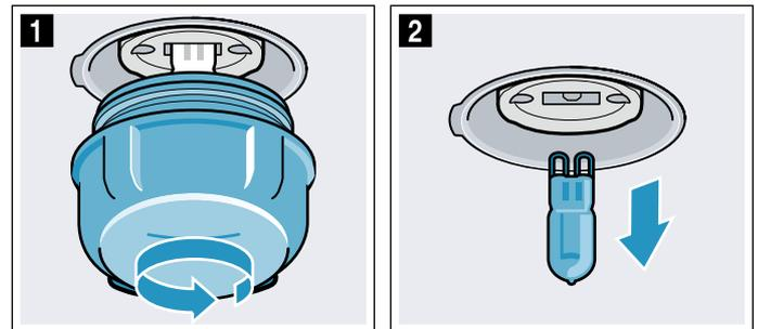
4. Glasabdeckung wieder eindrehen. Je nach Gerätetyp ist die Glasabdeckung mit einem Dichtring ausgestattet. Dichtring vor dem Eindrehen wieder aufsetzen.
