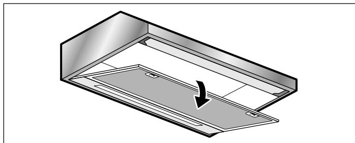
3. Filter spravitev poševen položaj in ga odstranite.
