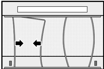
5. Ko odstranite klobučevinast maščobni filter, očistite notranjost aparata.
