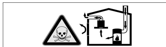
Vatrišta koja zavise od vazduha u prostoriji (npr. grejni uređaji na gas, ulje, drvo ili ugalj, protočni bojleri, kotlovi za zagrevanje vode) vazduh za sagorevanje crpe iz prostorije u koju su postavljeni i izduvne gasove izbacuju preko sistema za izduvne gasove (npr. kamoin) u spoljašnju sredinu.
