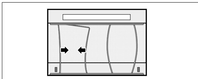
5. Posle demontaže filtera za mast od netkanog materijala uredaj očistite iznutra.
