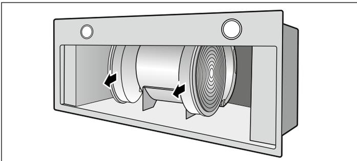
3. Sposare il filtro a carbone attivo a lato del motore.
