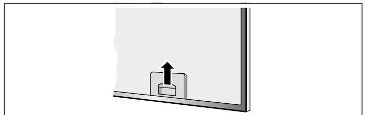
3. Sortir le filtre métallique à graisse de sa fixation.
