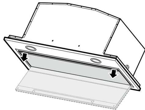
2. Ouvrir le verrouillage, puis abaisser le filtre métallique à graisse.
