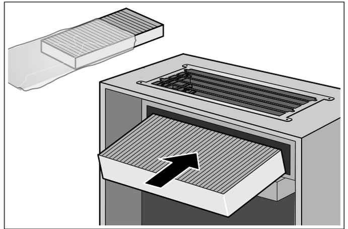
2. De afscherming zo inbrengen dat deze door de magneten wordt vastgehouden.
