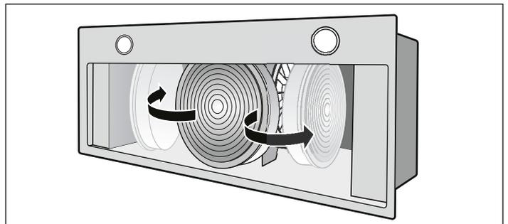
3. Pousser le filtre à charbon actif avec précaution dans les supports de fixation.
