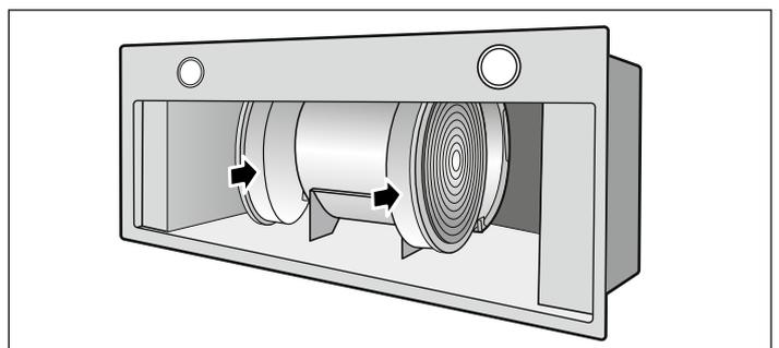
4. Mettre en place le filtre à graisse métallique.
