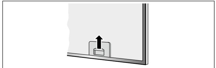
3. Metallfettfilter aus der Halterung herausnehmen.
