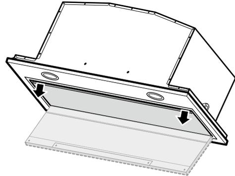
2. Verriegelung öffnen und den Metallfettfilter herunterklappen.
