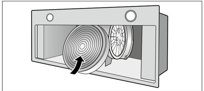
2. Sposare il filtro a carbone attivo a lato del motore.
