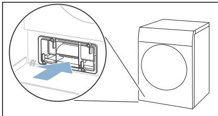
**Opomba:** Pokrov toplotnega izmenjevalnika lahko vstavite samo, ko je vložek v aparatu.
