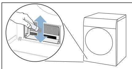
**Opomba:** Pazite, da lamele toplotnega izmenjevalnika čistite od zgoraj navzdol in da jih ne upognete ali poškodujete.
