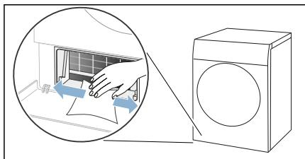
**Opomba:** Pazite, da ne poškodujete izpostavljenega toplotnega izmenjevalnika.
