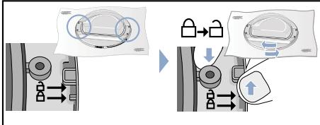
7. Heben Sie jetzt die Trocknertür vom Türring ab. Drehen Sie die Trocknertür und setzen diese wieder passend auf den Türring.
