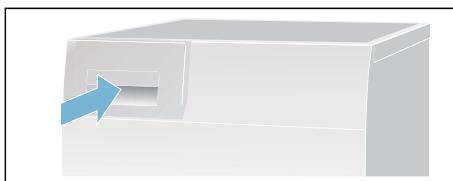
**Hinweis:** Das Sieb im Kondenswasser-Behälter filtert das Kondenswasser, das zur automatischen Reinigung Ihres Trockners verwendet wird. Das Sieb wird durch Entleeren des Kondenswassers gereinigt. Prüfen Sie das Sieb trotzdem regelmäßig auf verbliebene Ablagerungen und entfernen diese. Siehe → Seite 45.
