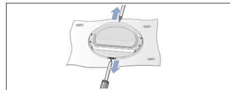
9. Entfernen Sie die die Ringe von der Trocknertür.
