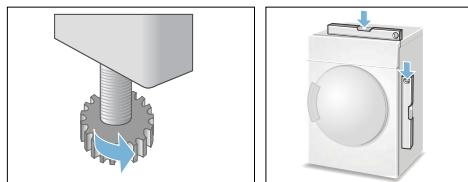
Falsches Ausrichten kann laute Geräusche, Vibratoren und fehlerhafte Trommelbewegungen verursachen.
