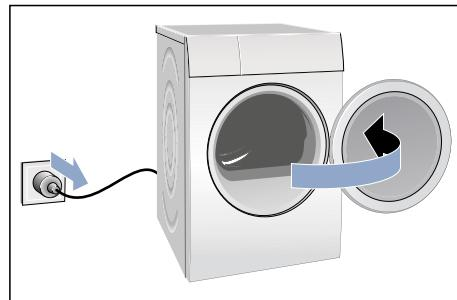
2. Entfernen Sie die Schrauben am Trockner und nehmen Sie die Trocknertür anschließend ab.
