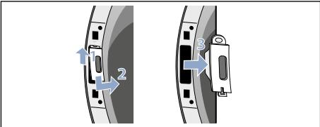
17. Setzen Sie das Türschloss (1.) auf der anderen Seite des Trockners ein und schrauben Sie die Abdeckung (2.) wieder an.
