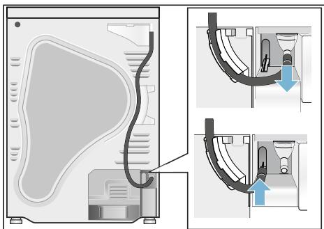
4. Nehmen Sie den Ablaufschlauch aus dem Zubehör und befestigen diesen am leeren Stutzen.
