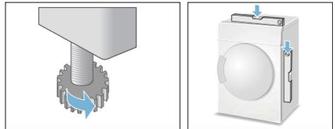
Falsches Ausrichten kann laute Geräusche, Vibrationen und fehlerhafte Trommelbewegungen verursachen.
