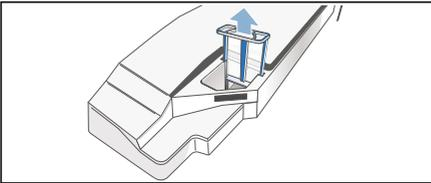
4. Reinigen Sie das Sieb unter fließendem warmen Wasser oder in der Geschirrspülmaschine.
