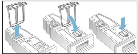
9. Schieben Sie den Kondenswasserbehälter bis zum Einrasten ein.
