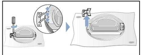
5. Entfernen Sie die Schrauben vom Türgriff der Trocknertür und nehmen diesen ab.
