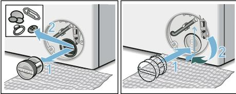
6. Service-Klappe einsetzen, einrasten und schließen.
