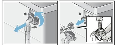
3. Schlauch anschließen und auf Dichtheit prüfen.
