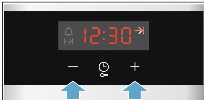
Aparat čez nekaj sekund prevzame nastavitev. Na prikazovalniku je prikazan čas konca priprave. Tako ko aparat začne delovati, se čas trajanja odšteva.
