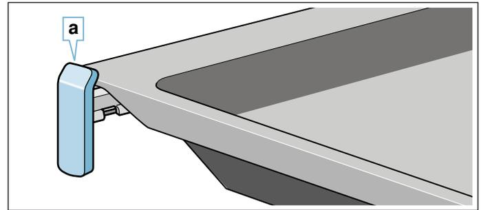
Los rieles de extracción se encajan cuando están totalmente extraídos. De esta manera, el accesorio puede colocarse fácilmente. Para desencajarlos, volver a introducir los rieles de extracción en el compartimento de cocción ejerciendo un poco de presión.
