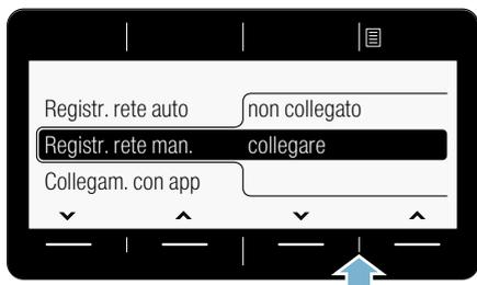
L'apparecchio stabilisce ora una rete WLAN con il nome della rete (SSID) **HomeConnect**, alla quale è possibile accedere dal vostro smartphone o tablet PC.
