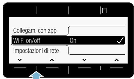
4. Con uno dei due tasti a freccia a destra selezionare **attivato** o **disattivato** per attivare o disattivare il Wi-Fi.
