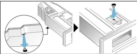
8. Estrarre il filtro dallo scomparto e inserirlo nell'incavo del contenitore dell'acqua di condensa.
