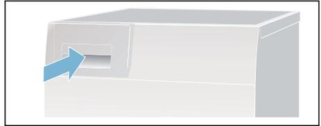
**Avvertenza:** Il filtro nel contenitore dell'acqua di condensa filtra l'acqua di condensa che viene utilizzata per la pulizia automatica dell'asciugatrice. Svuotando l'acqua di condensa il filtro viene pulito. Ciononostante controllare regolarmente che non ci siano depositi di impurità nel filtro. In caso contrario, rimuoverli. Vedere → *Pagina 46*.
