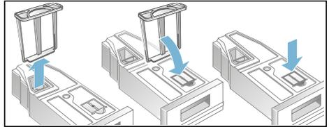
9. Inserire il contenitore dell'acqua di condensa fino all'arresto.
