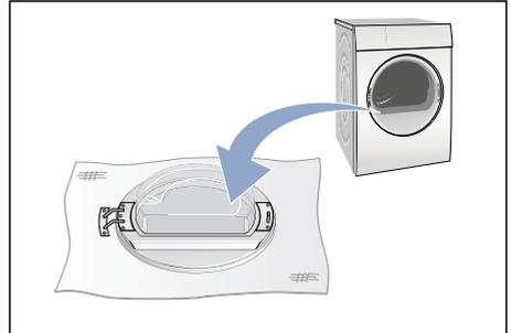
4. Entfernen Sie jetzt die Schrauben vom Türgelenk und nehmen dieses von der Trocknertür ab.
