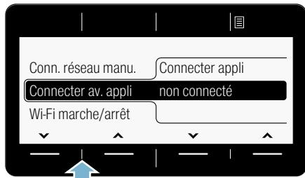
5. Sélectionnez, à l'aide de l'une des deux flèches de droite, **Connecter appli**.
