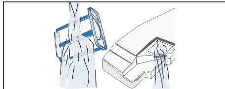
5. Insérez le filtre jusqu'à ce qu'il s'encliquette.
