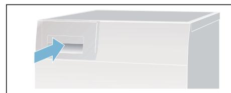
**Remarque :** Le filtre du réservoir d'eau de condensation filtre l'eau de condensation utilisée pour le nettoyage automatique de votre sèche-linge. Le filtre est nettoyé en vidant l'eau de condensation. Vérifiez régulièrement que le filtre ne contient pas de dépôt et retirez-les le cas échéant. Voir → Page 48.
