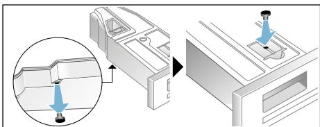
8. Retirez le filtre du crantage et placez-le dans la cavité du réservoir d'eau de condensation.
