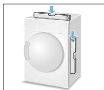
Un mauvais alignement peut entraîner des vibrations et des mouvements incorrects du tambour.
