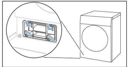
4. Wärmetauscher-Abdeckung am Griff herausziehen.
