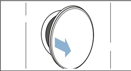
2. Feuchtigkeitssensor mit angerauhtem Schwamm reinigen.
