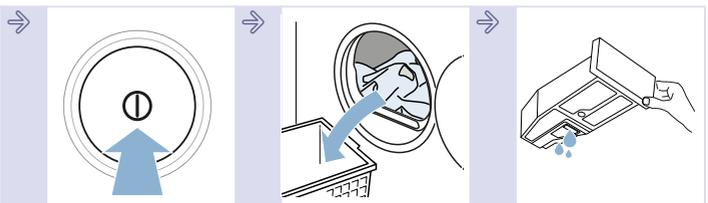
Gerät ausschalten.      Tür öffnen und Wäsche entnehmen.      Kondenswasserbehälter entleeren.
