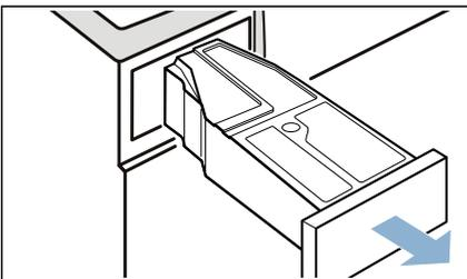
9. Den Kondenswasser-Behälter bis zum Einrasten einschieben.
