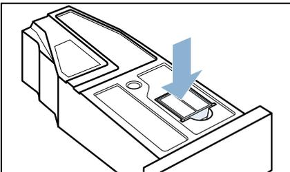
12. Den Kondenswasser-Behälter bis zum Einrasten einschieben.
