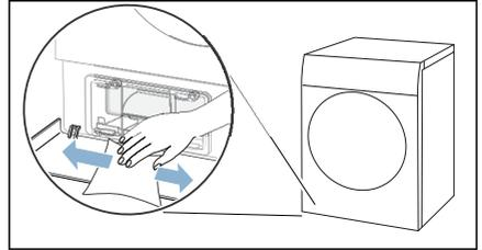
3. Hebel der Wärmetauscher-Abdeckung entriegeln.
