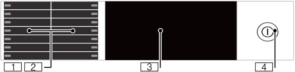
**1** **Programmtasten:** Programm einstellen durch leichtes, mittiges Drücken.
