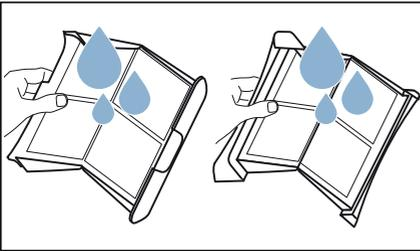
8. Flusensiebe abtrocknen, zuklappen und wieder einsetzen.
