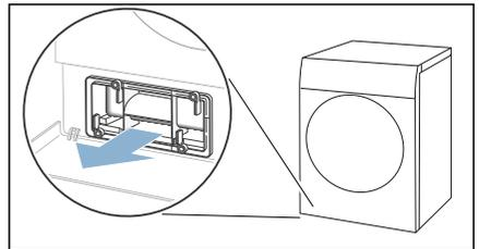
5. Wärmetauscher-Abdeckung mit weicher Bürste reinigen.
