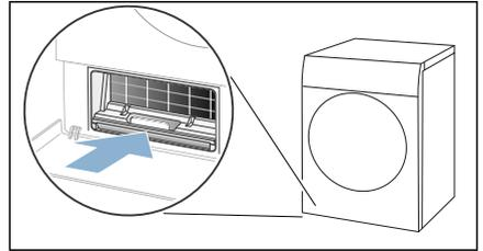
10. Wärmetauscher-Abdeckung am Griff einschieben.
