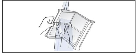
7. Trocknen Sie die Flusensiebe ab, klappen diese zu und setzen das zweiteilige Flusensieb wieder ein.
