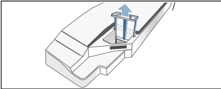
4. Reinigen Sie das Sieb unter fließendem, warmem Wasser oder in der Geschirrspülmaschine.
