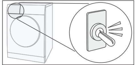
Das Kondenswasser wird mit einer Pumpe in den Kondensatbehälter gepumpt. Dabei entstehen Pumpgeräusche.
