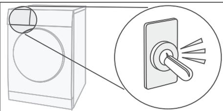
Das Kondenswasser wird mit einer Pumpe in den Kondensatbehälter gepumpt. Dabei entstehen Pumpgeräusche.
