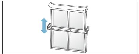
5. Klappen Sie beide Siebe auf und entfernen alle Flusen.
