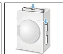
Falsches Ausrichten kann laute Geräusche, Vibratoren und fehlerhafte Trommelbewegungen verursachen.
