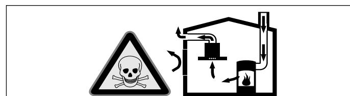
Зависимите от стайнния въздух печки (напр. нагревателните уреди, работещи с газ, нафта, дърва или въглища, конвекторните нагреватели, калориферите) изтеглят въздух за изгаряне от мястото на поставяне и изкарват отработени газове през съоръжение за отработени газове (напр. димоотвод) на открito.
