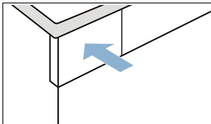
**Υπόδειξη:** Η σήτα στο δοχείο συμπυκνώματος φιλτράρει το συμπύκνωμα, το οποίο χρησιμοποιείται για τον αυτόματο καθαρισμό της συσκευής σας. Η σήτα καθαρίζεται με το άδειασμα του συμπυκνώματος. Ελέγχετε παρόλ' αυτά τη σήτα τακτικά για παραμένοντα αποθέματα και ενδεχομένως αφαιρέστε τα.
