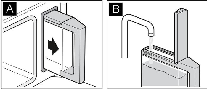
3. 关闭水箱盖，直到感觉已经卡到位。
