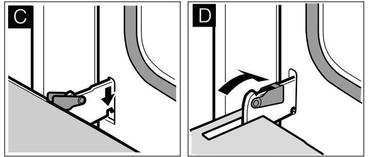
电器门锁定，无法再拆卸。
