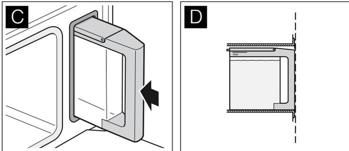
水箱必须与水箱安装槽齐平 (图 D)。
