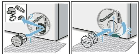
6. Service-Klappe einsetzen, einrasten und schließen.
