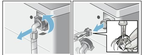
3. Schlauch anschließen und auf Dichtheit prüfen.
