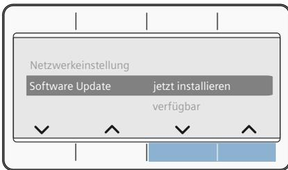
**Hinweis:** . Das Aktualisieren der Software kann mehrere Minuten dauern. Schalten Sie das Gerät während der Aktualisierung nicht aus.
