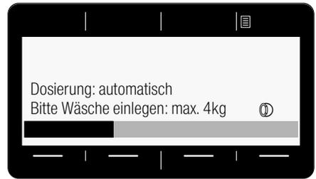
Der Beladungsbalken füllt sich beim Einfüllen der Wäsche. Ist die max. Beladung überschritten, blinkt der Balken. Beachten Sie die angegebene max. Beladung. Überfüllung mindert das Waschergebnis und fördert Knitterbildung.
