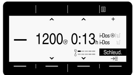
Zum Ändern die Taste unter dem schwarz hinterlegten Programm wählen und Programm ändern.
