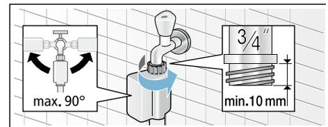
**Hinweis:** . Wasserhahn vorsichtig öffnen und dabei Dichtheit der Anschluss-Stellen prüfen. Schraubverbindung steht unter Wasserleitungsdruck.
