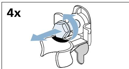
3. Retirar los manguitos. Retirar para ello el cable de conexión de las sujeciones.
