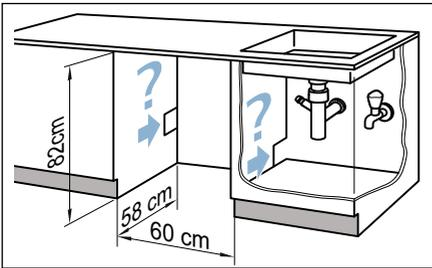
3. Tender el cable de conexión a la red eléctrica y las mangueras. Introducir el aparato y al mismo tiempo arrastrar el cable de conexión a la red eléctrica y las mangueras.
