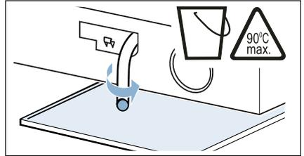
7. Encajar el tubo auxiliar de desagüe en la sujeción.
