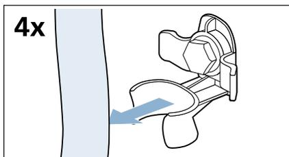
2. Aflojar y retirar los 4 tornillos de fijación para el transporte con una llave de tuercas con distancia entre caras 13.
