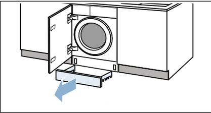
4. Extraer el tubo auxiliar de desagüe de su soporte.
