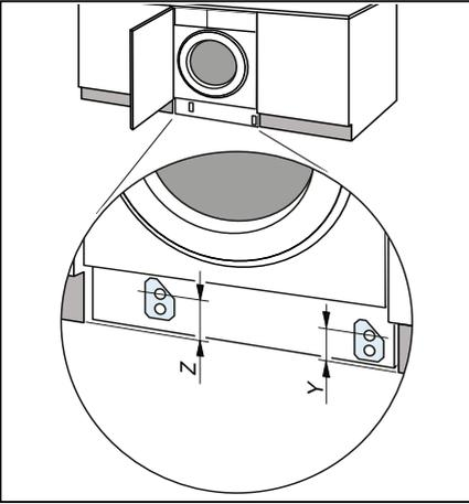
15. Atornillar el tope de deslizamiento de modo acorde con las medidas.
