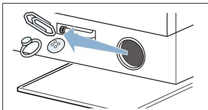
10. Montar la tapa de la bomba en su sitio y enroscarla. El asa de la tapa de mantenimiento tiene que estar en posición vertical.
