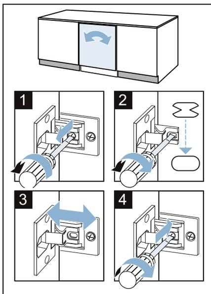
13. Colocar el tope de deslizamiento del panel de zócalo.
