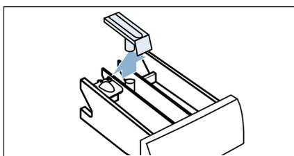
4. Lavar el compartimento para detergente y la pieza insertada con agua y un cepillo y secarlas.
