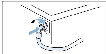
**Nota:** Abrir el grifo de agua cuidadosamente y verificar la estanqueidad de los empalmes. Las conexiones roscadas están sometidas a la presión de las tuberías de agua.
