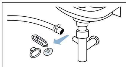
4. Colocar de nuevo la manguera de evacuación y asegurar los puntos de empalme apretando la abrazadera.
