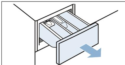
2. Presionar hacia abajo la pieza insertada y extraer el cajón completamente.
