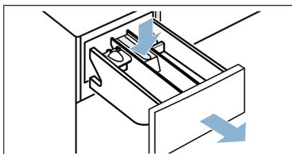
3. Extraer la pieza insertada: presionarla con el dedo de abajo hacia arriba.
