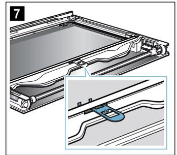
6. Innenscheibe schräg nach hinten in die Halteschiene **d** einsetzen (Bild **8**).
