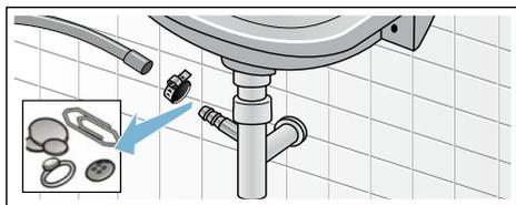
4. Voltar a colocar a mangueira de escoamento e fixar o local de ligação com a braçadeira.
