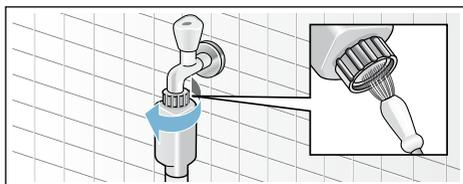
2. Nos modelos Standard e Aqua-Secure, limpar o filtro de rede na parte traseira do aparelho:
