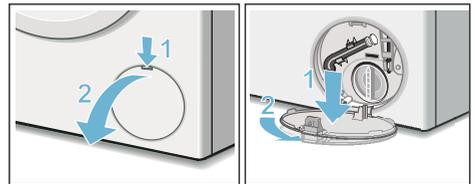
4. Retire a mangueira de esvaziamento do suporte. Retire a tampa de fecho e deixe correr a água para um recipiente adequado. Volte a colocar a tampa de fecho e coloque a mangueira de esvaziamento no suporte.
