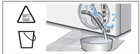
5. Desenroscar com cuidado a tampa da bomba, deixar sair a água restante. Limpar o interior, a rosca da tampa da bomba e a estrutura da bomba. A roda de pás da bomba de
