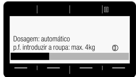
As barras de carga enchem-se na introdução da roupa. Se a carga máxima for ultrapassada, a barra pisca. Ter em atenção a carga de roupa máxima indicada. Uma carga de roupa excessiva reduz o resultado de lavagem e favorece a formação de vincos.
