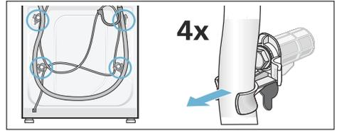
2. Desapertar todos os 4 parafusos dos dispositivos de segurança para transporte e retirá-los com uma chave SW13. Retirar as mangas. Retire o cabo elétrico dos suportes.
