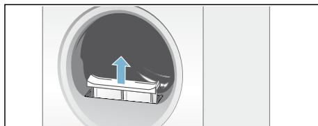
3. Odstranite vsa vlakna iz vdolbine na filteru za vlakna.
