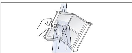
7. Filtra za vlakna posušite, ju poklope in ponovno vstavite dvodelni za vlakna v sušilni stroj.
