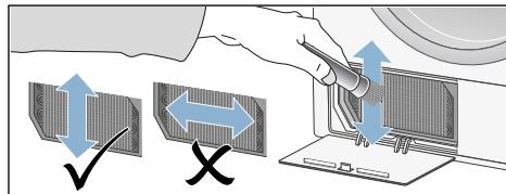
**Opomba:** Pri čiščenju pazite, da ne upognete ali poškodujete lamel topotnega izmenjevalnika.
