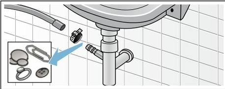
4. Voltar a colocar a mangueira de drenagem e fixar o local de ligação com a braçadeira.
