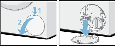
4. Retirez le tuyau de vidange de sa fixation. Retirez le capuchon d'étanchéité et laissez l'eau couler dans un récipient adapté. Remplacez le capuchon d'étanchéité et placez le tuyau de vidange dans la fixation.
