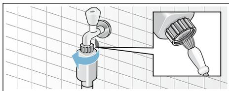
6. Pour les modèles standards et Aqua-Secure, nettoyez le filtre à l'arrière de l'appareil : Retirez le tuyau de l'arrière de l'appareil. Utilisez des pinces pour retirer le filtre, puis nettoyez-le.
