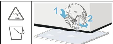
5. Dévissez avec précaution le couvercle de la pompe ; de l'eau résiduelle peut s'écouler. Nettoyez l'intérieur, le filetage du couvercle de la pompe et le boîtier de la pompe. Le rotor de la pompe de vidange doit pouvoir tourner librement. Remettez le couvercle de la pompe et vissez-le fermement en place. La poignée doit être à la verticale.
