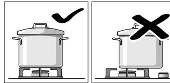
Nádoby umísťujte přesně na střed hořáku. V opačném případě by mohlo dojít k jejímu převržení. Nepokládejte velké nádoby na hořáky v blízkosti ovládacích knoflíků. Může dojít k poškození knoflíků v důsledku působení příliš vysokých teplot.
