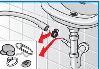
3. Ablaufschlauch wieder aufstecken und Anschluss-Stelle mit Schlauchschelle sichern.
