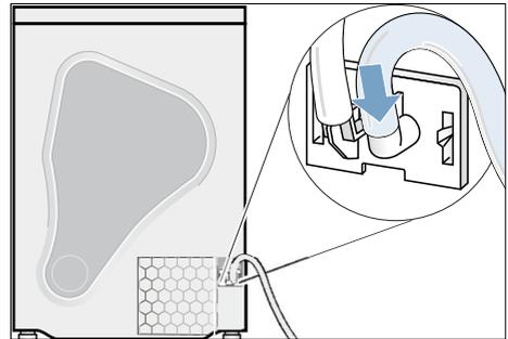
6. Fijar el otro extremo de la manguera de desagüe con el resto de accesorios en función del caso de conexión (A, B o C).
