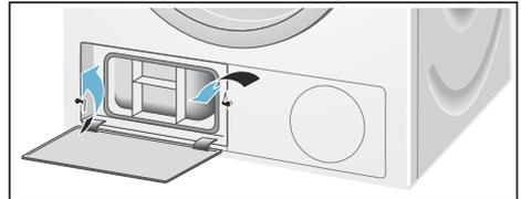
4. Extraer la pieza superpuesta del intercambiador de calor.
