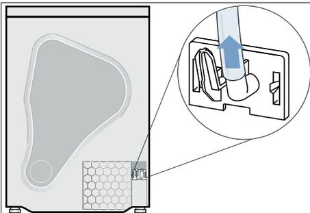
4. Colocar la manguera del agua condensada en posición de parada.
