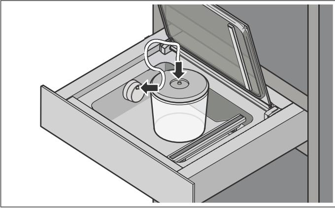
2. Placez l'adaptateur de vide sur la sortie d'air.
