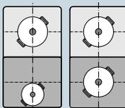
Zone de gătit din față și din spate, fiecare cu două inductoare, pot fi utilizate independent unele de altele. Setati treapta de fierbere dorită pentru fiecare zonă de gătit individuală. Pe fiecare zonă de gătit utilizați numai un sigur vas de gătit.
