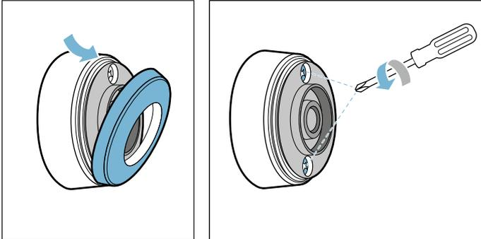
2. Scoateți partea superioară a carcasei. Îndepărtați vechea baterie. Introduceți bateria nouă. Acordați atenție polarității.
