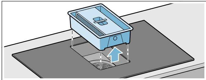
**Merk:** Det kan samle seg fett nede i beholderen. Hold metallfettfilteret vannrett for å forhindre at det drypper fett fra det.
