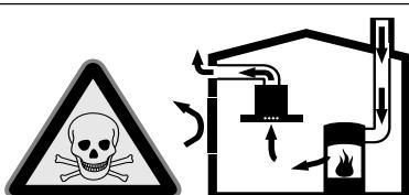
Ildsteder som er avhengig av romluft (f.eks. varmeapparater som drives med gass, olje eller kull, varmtvannsberedere) bruker forbrenningsluften fra oppstillingsrommet og leder avgassene gjennom et avgassanlegg (f.eks. pipe) i det fri.
