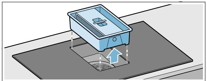
**3.** Trykk på lukkeelementene på begge sider av beholderen for å løsne metallfettfilteret fra beholderen.
