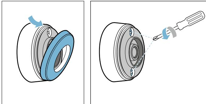
2. Trekk av overdelen av huset. Ta ut det gamle batteriet. Sett inn det nye batteriet. Pass på at polene kommer riktig vei.
