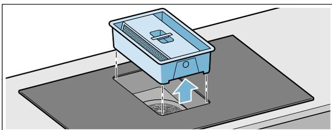
**Remarque :** La graisse peut s'accumuler dans le bas du réservoir. Pour éviter tout égouttement de graisse, n'inclinez pas le filtre à graisse métallique.
