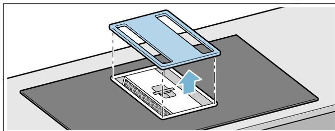
2. Retirez le filtre à graisse métallique et le réservoir.
