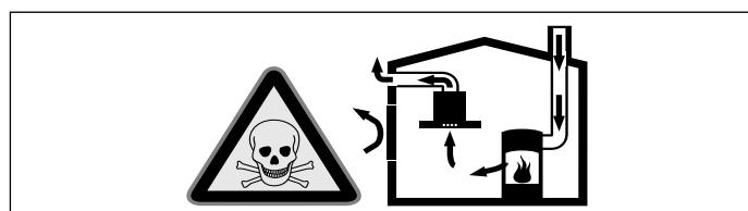
Hava dolaşımı ateşlikler (örneğin gaz, yağı, odun veya kömürle çalışan sobalar, şofbenler, su ısıtıcıları) yanma havasını kurulum yerinden alırlar ve atık gazi bir atık gaz sistemi (örneğin baca) kanalıyla dışarıya aktarırlar.
