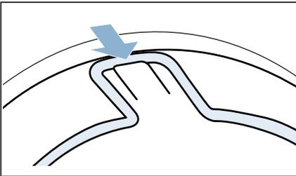
Le panier pour lainages doit maintenant être fixé au capot avant.
