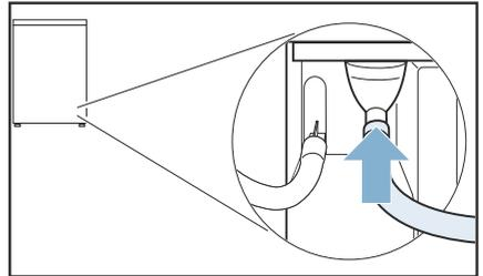
6. Selon la situation de raccordement, fixez l'autre extrémité du tuyau d'évacuation avec les accessoires restants.
