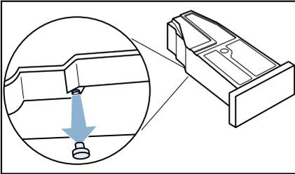
9. Tournez le réservoir d'eau de condensation de nouveau à 180° et introduisez le bouchon dans la cavité située sur le dessus du réservoir d'eau de condensation.
