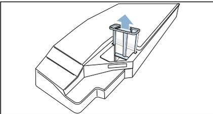
11. Placez le filtre dans la cavité du réservoir d'eau de condensation.
