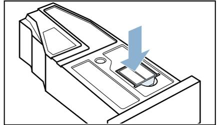
12. Poussez le réservoir d'eau de condensation jusqu'à ce qu'il s'enclenche.
