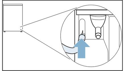
5. Retirez le tuyau d'évacuation, fixez-le sur les supports détachés et poussez-le jusqu'en butée.
