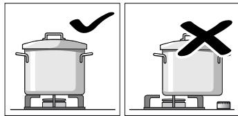
Umieszczać naczynie na palniku w położeniu dokładnie centrycznym. W przeciwnym razie może się ono wywrócić. Nie stawiać dużych naczyń na palnikach blisko pokręteł. Może to spowodować uszkodzenie pokręteł na skutek wysokiej temperatury.
