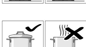
Az edényeket mindenkor közepére helyezze. Ellenkező esetben az edény felborulhat. Ne tegyen nagy edényeket azokra az égőkre, amelyek közel vannak a kapcsolóhoz. Ez károkot okozhat a túl magas hőmérséklet miatt.
