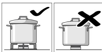
Așezați recipientele pe grătare, niciodată direct pe arzător.
