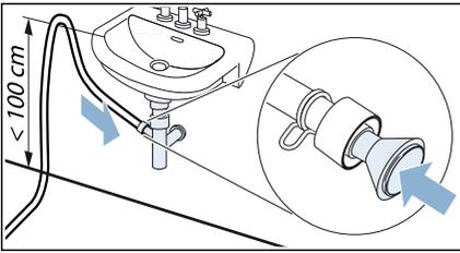
Το σημείο σύνδεσης πρέπει να ασφαλιστεί με περιλαίμιο εύκαμπτου σωλήνα (περιοχή σύσφιξης 12-22 mm, ειδικά καταστήματα).
